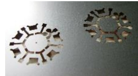
Substratos cerámicos (“LED-boards”)
