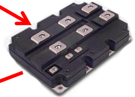
Módulo de potencia
